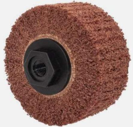
Qualitativ sehr **hochwertiges Vliesgewebe** für besonders **lange Lebensdauer**. Erzeugt einen **schattenfreien Industrieschliff** (Mattieren, Satinieren). Auch zum Vorpulieren, **Entfernen von Oxidschichten** sowie zum **Angleichen „vorgeschliffener“ Bleche** und Glätten von Oberflächen. Mit vibrationsdämpfender Kreuznut-Hülse und M14 Gewindeeinsatz für 100 % Rundlaufgenauigkeit.
